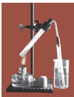
Fig. 4.6. Distilarea apei naturale într-o instalație simplă
