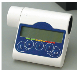
Fig. 3.15. Spirometru – aparat pentru măsurarea volumului de aer respirat.
