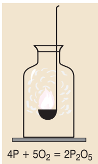
Fig. 2.4. Reacția de combinare dintre fosfor și oxigen.
