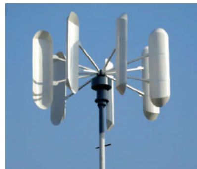
Fig. 6. Turbină eoliană tangențială
