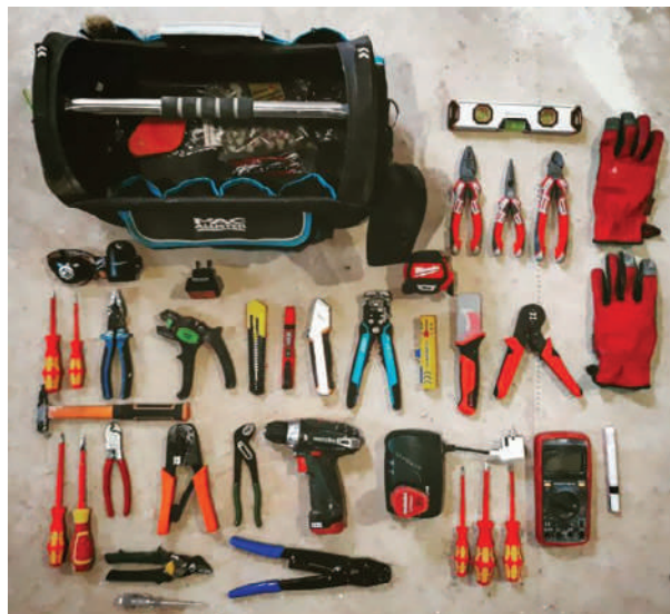
Fig. 25. Echipament și instrumente necesare unui electromontor-reparator
