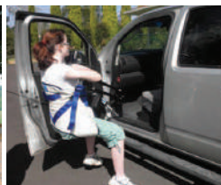
Fig. 10. Dispozitive pentru accesul în automobil al persoanelor cu dizabilități locomotoare
