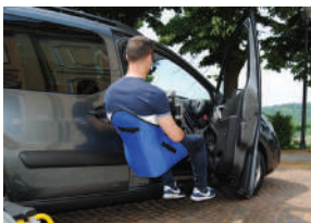
Fig. 10. Dispozitive pentru accesul în automobil al persoanelor cu dizabilități locomotoare
