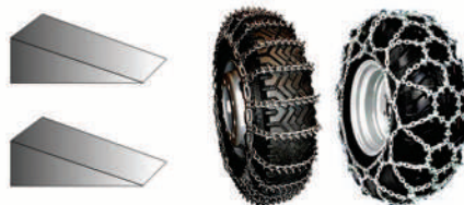
Fig. 24. Pene pentru asigurarea staționării și lanțuri antiderapante
