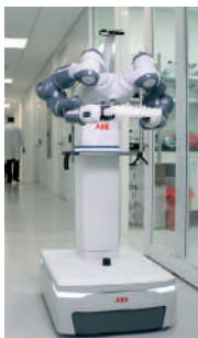
Fig. 8. Robotul YuMi ajută la supravegherea sistemelor de manipulare a eprubetelor
