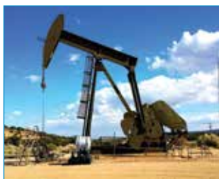
Штанговый глубинный насос для добычи нефти
