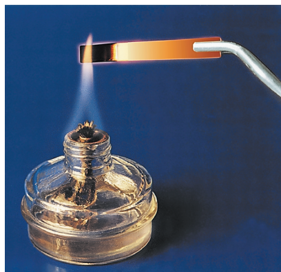
Рис. 2.2. Образование оксида меди (II) (черного цвета) при прокаливании меди в кислороде воздуха
